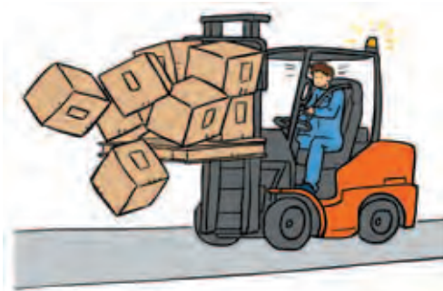
Riesgo: carga sin sujeción
