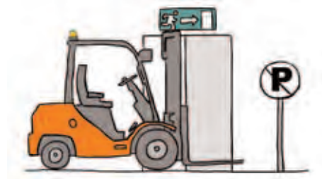
No sitúes la carretilla en salidas de evacuación o emergencia
