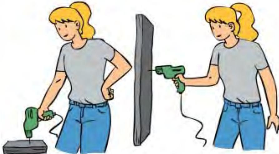
Una herramienta de empuñadura recta es adecuada para trabajar sobre una superficie horizontal a la altura del codo o sobre una vertical por debajo de la cintura. Si es utilizada sobre una superficie horizontal por debajo del codo o sobre una vertical a la altura del codo, produce desviación cubital de la muñeca.
