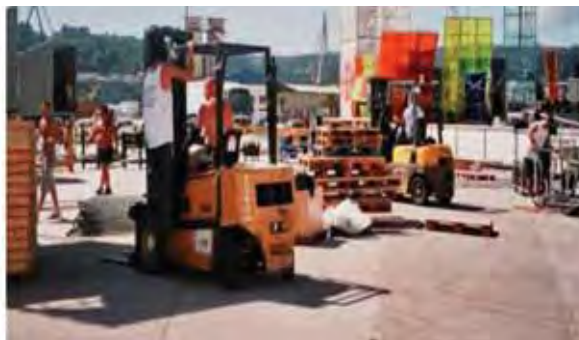
No está permitido el transporte de trabajadores en carretilla
