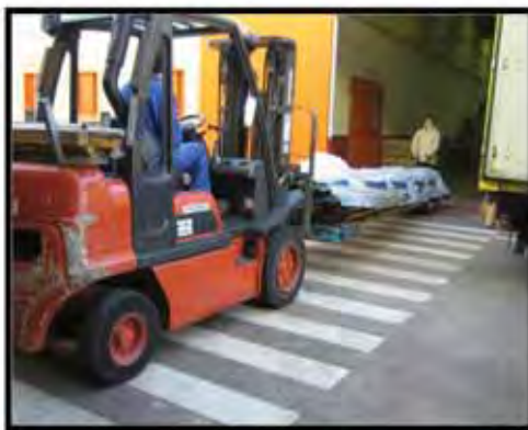
Utilización de la carretilla para uso no previsto (empuje y arrastre)
