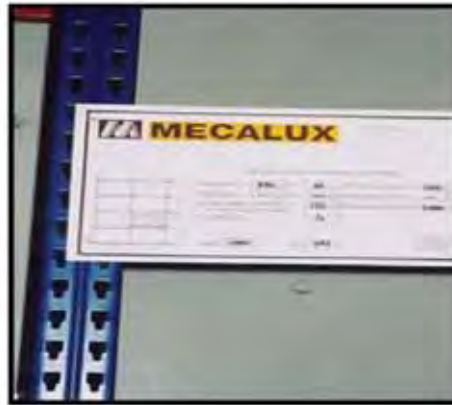
Identificación de la carga en la estantería
