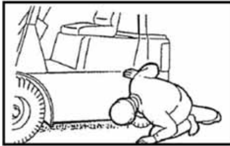
La presencia de manchas de combustible, aceite o refrigerante en el suelo
