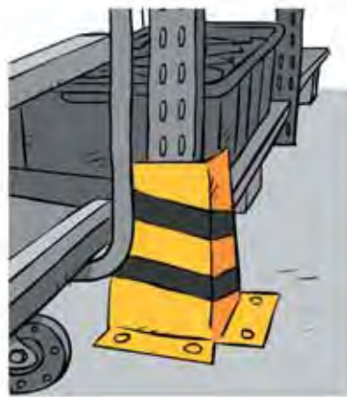
Protección de puntales con colores de seguridad
