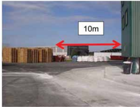
Separación entre paletas y edificación
