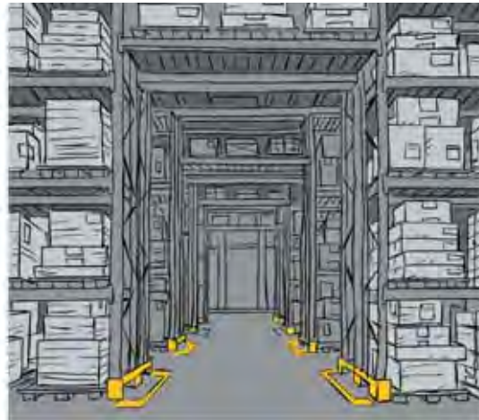
Túnel de paso
