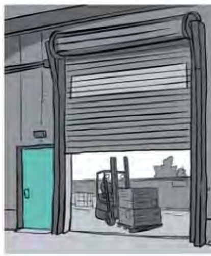
Puerta de entrada de trabajadores situada al lado del acceso general de los vehículos
