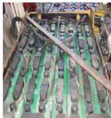
Batería de una carretilla elevadora con sistema antivuelco
