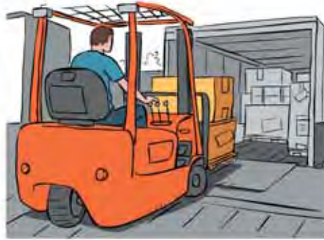
Las plataformas sueltas como pasos para cargar y descargar de los vehículos no están permitidas
