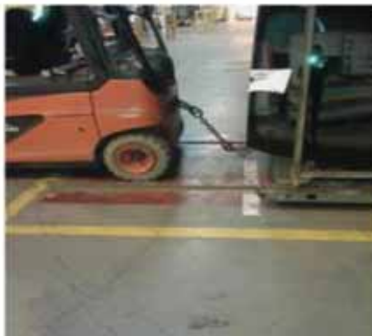
Carretilla elevadora autopropulsada que de forma ocasional se utiliza para remolque
