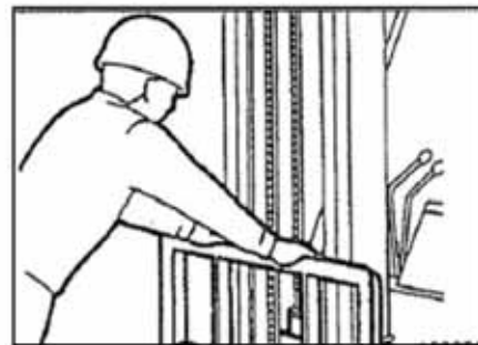
El respaldo (deformación, grietas...)
