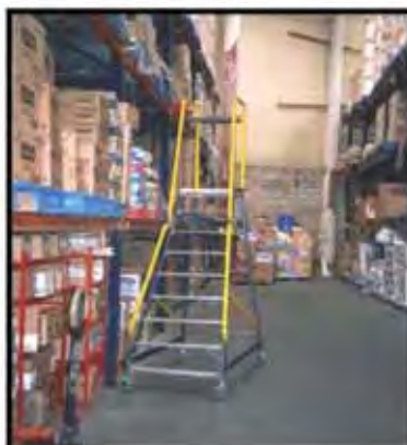
Medio de acceso seguro mediante escaleras móviles
