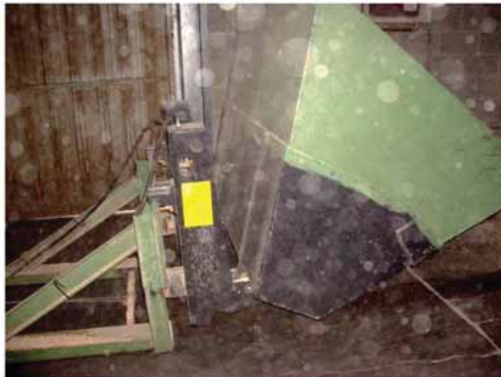
Equipo intercambiable: volteador acoplado a una carretilla elevadora
